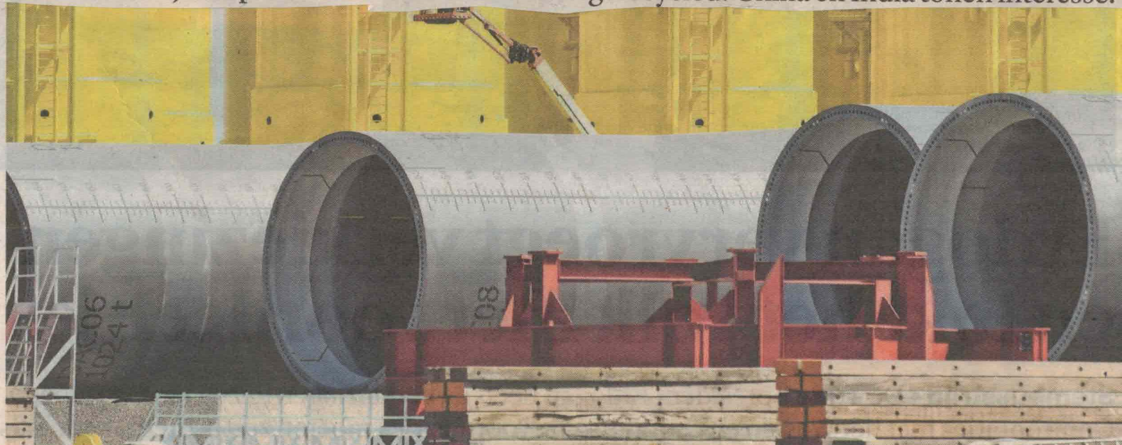
Op de Rotterdamse Maasvlakte worden stalen buizen gemaakt voor de fundering van windmolens en gasplatforms. FOTO ANP
